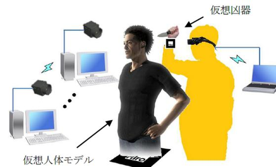
(b) 重畳表示後：複数台の Web カメラにより映像を取得する。その映像のマーカ上に仮想凶器や仮想人体モデルを表示する。
