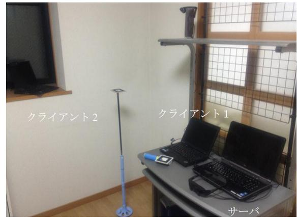
図 4 実験環境：HMD を接続したサーバと Web カメラを接続したクライアントを 2 台配置する。これらにより映像とマーカ情報を取得する。
