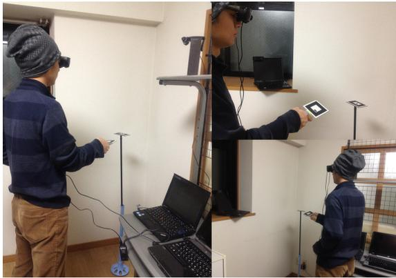
図 6 操作風景：演技者は HMD を装着し，仮想凶器用マーカを手を持つ．被害者用マーカを配置し，Web カメラを被害者用マーカが入るように調節する．
